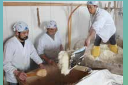
蒸した米を冷ますため、放冷機へと移す。蒸し米は重く、手作業で移すのはかなりの重労働
